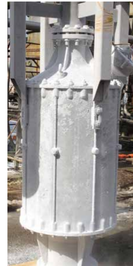
Насос НСПГ 900–120 после натурных испытаний
